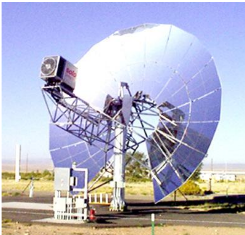
Obr. 3. Fungujúci prototyp tanierového/Stirlingového systému navrhnutého a inštalovaného v USA.
